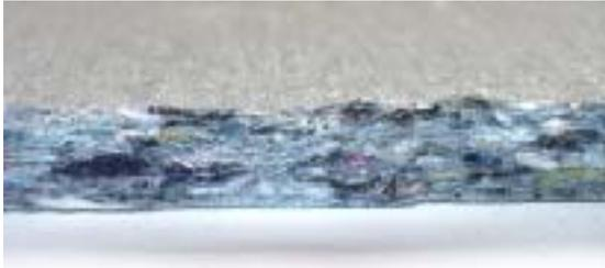
Das spezielle Dämmmaterial besteht aus locker verbundenen Textilfasern. Es ist selbstklebend.
