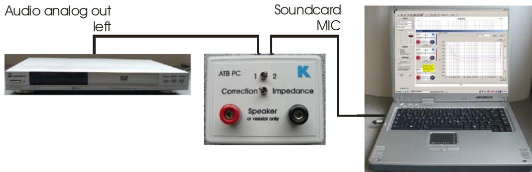
Die Funktion der System-Correction testet den Frequenz- und Phasengang der Soundkarte. Hierbei werden Korrekturdateien erzeugt, mit denen die hohe Messgenauigkeit erreicht wird.
