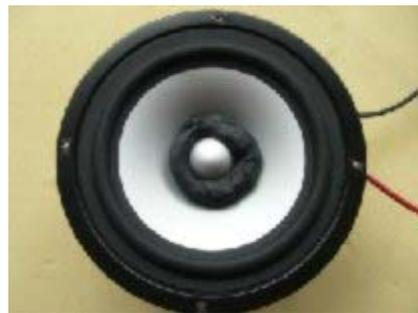
Für die Impedanzmessung wird der Lautsprecher senkrecht gehalten oder auf Schaumstoff gelegt.
