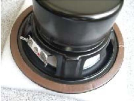
Der Tieftöner wird mit einer Dauerdichtung für Fenster und Türen, 4x9mm, abgeklebt
