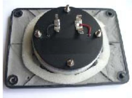
Beim Hochtöner können die Hohlräume in der Montageplatte mit der Acryl-Dichtung ausgefüllt werden. Hierdurch wird die Platte akustisch günstiger als eine Metallplatte. Abgeklebt wird der Hochtöner mit Schaumstoff.
