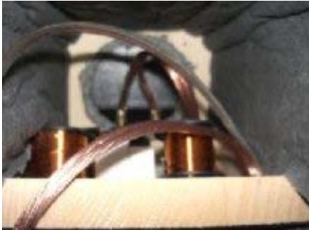
Die Lage der Weiche in der Box. Gut ist die eingeklebte Anschlussdose zu sehen.
