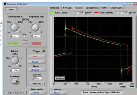
Bild 3.1.3 Korrigiertes Rechtecksignal
