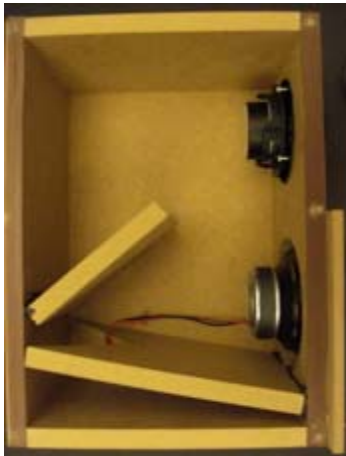
Bild 2.15 Brett Um die stehenden Wellen im Gehäuse zu unterdrücken, wird das Brett eingesetzt
