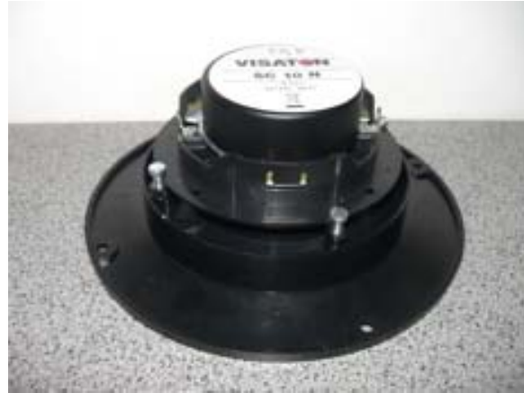
Bild 1.18 Der Waveguide und Kalotte Der Waveguide wird mit der Kalotte verschraubt. Hierfür müssen in die Frontplatte der Kalotte Halblöcher gefräst werden.
