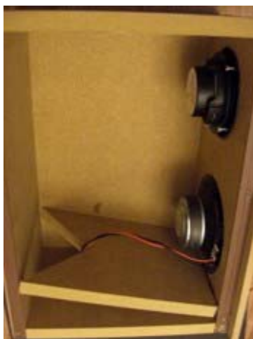
Bild 2.13 gewähltes Gehäuse Der dreieckige Ausschnitt des Brettes vermindert Strömungsgeräusche
