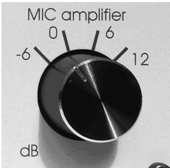
Um in den optimalen Aussteuerbereich bei der Mikrofon Messung zu erhalten, kann die Verstärkung des Mikrofonverstärkers eingestellt werden. Bei der Mikrofon Kalibrierung mit einem Kalibrator wird der Verstärker auf 0 gestellt. Wird diese Einstellung verändert, muss der entsprechende dB Wert bei dem Messergebnis berücksichtigt werden.
