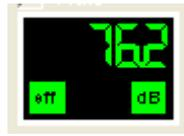
Das Levelmeter zeigt den RMS Schalldruck in dB.
